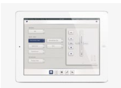
KNX / gBUS Steuerung per iPad
