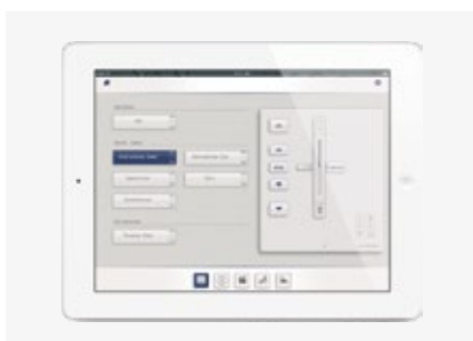
KNX / gBUS Steuerung per iPad
