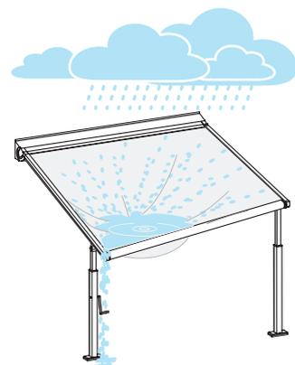
Bei Überschreiten der Regenklasse 2 (56l/h/m<sup>2</sup>) muss die Plaza Viva zwingend eingefahren werden. Beschädigungsgefahr!
